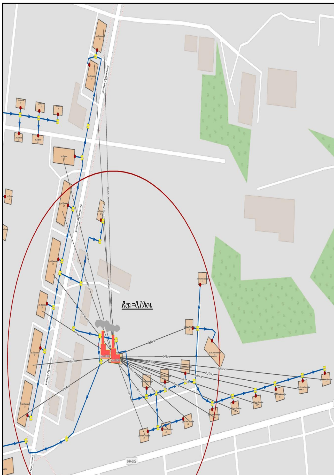
Рисунок 2.5.7 – РЭТС котельной «ПМК-1»
