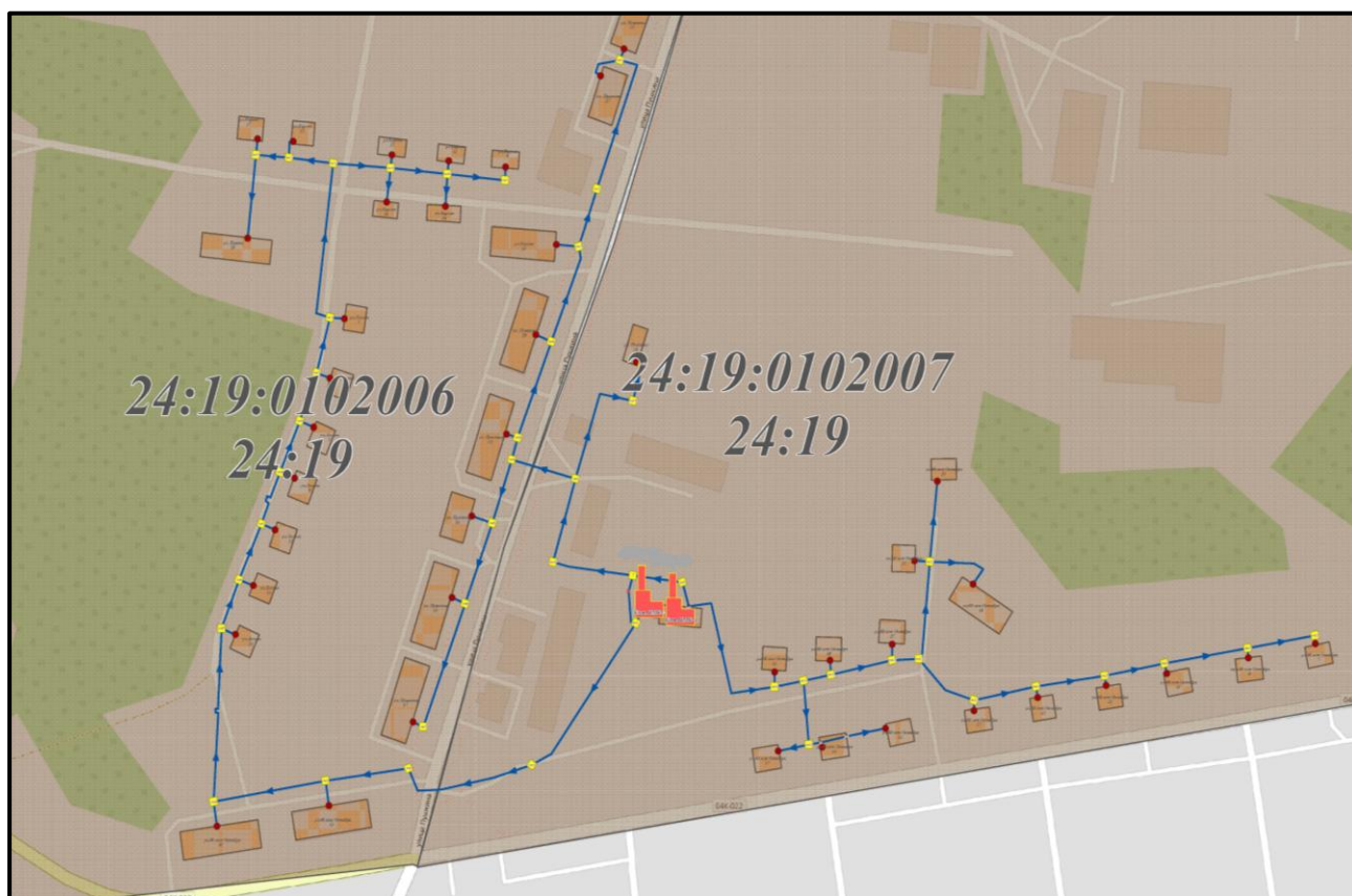
Рисунок 2.4.7 – Зона действия котельных «ПМК-1;2» (кадастровый квартал)
