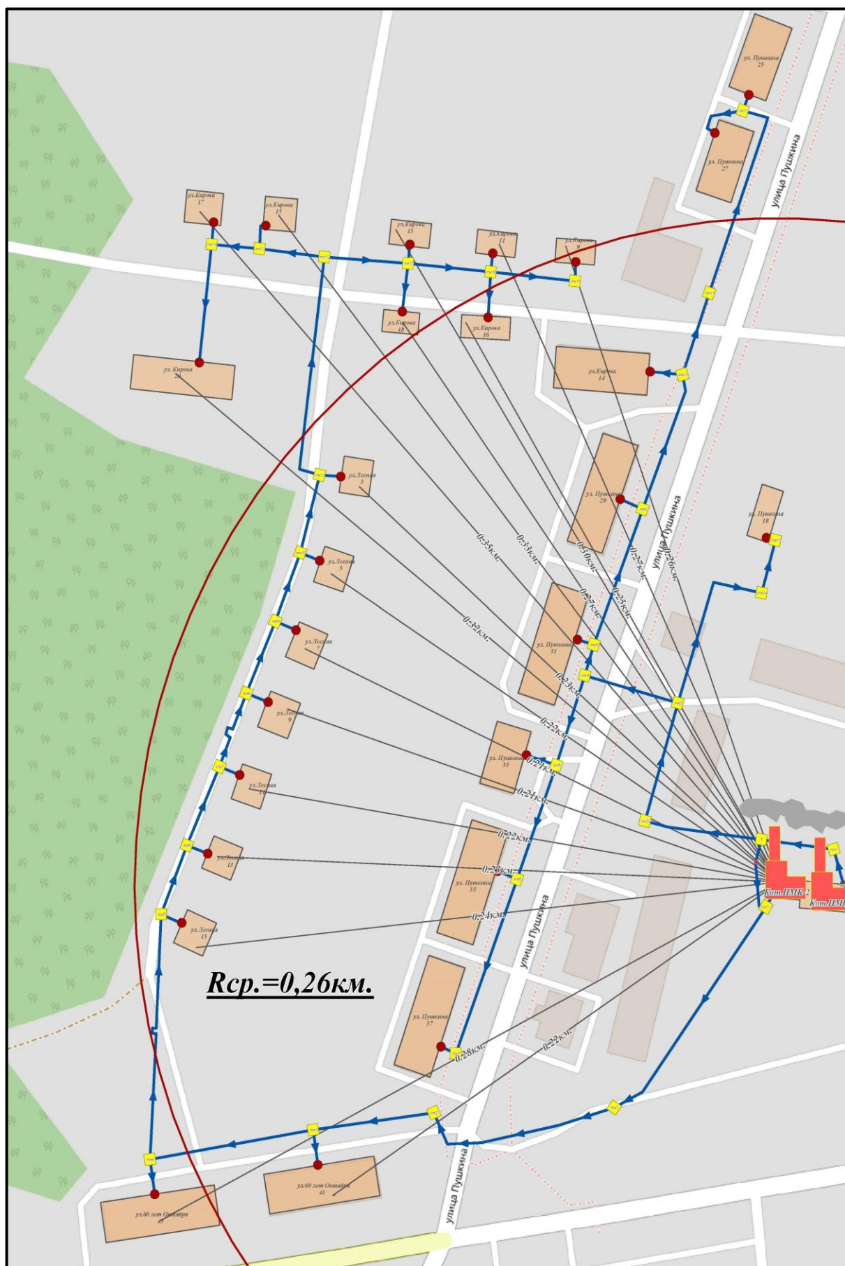
Рисунок 2.5.8 – РЭТС котельной «ПМК-2»
